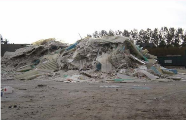
Stockage des composites en plein air – produits inerte sans problème de lixiviation
